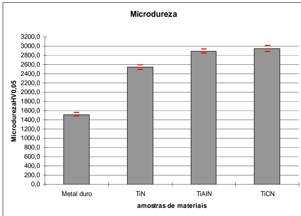
Figura 4.1 - Apresenta as medidas de microdureza Vickers do substrato de metal duro e dos substratos com revestimentos.
