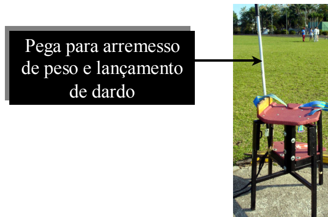
Figura 4.7 - Pega lateral para arremesso de peso e lançamento de dardo
