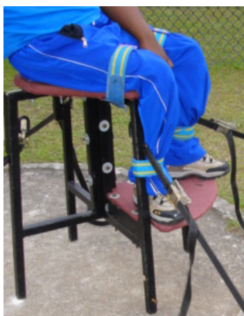
Figura 5. 6 - Fixações do Paraatleta na cadeira de arremesso
