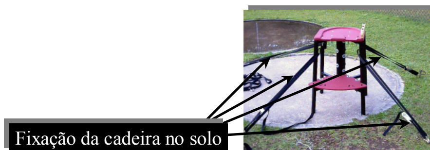
Figura 4.8 - Fixação da cadeira no solo
