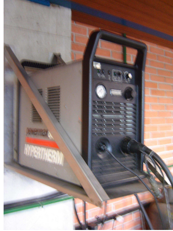
Figura 4.3- Fonte da tocha plasma utilizada neste trabalho.
