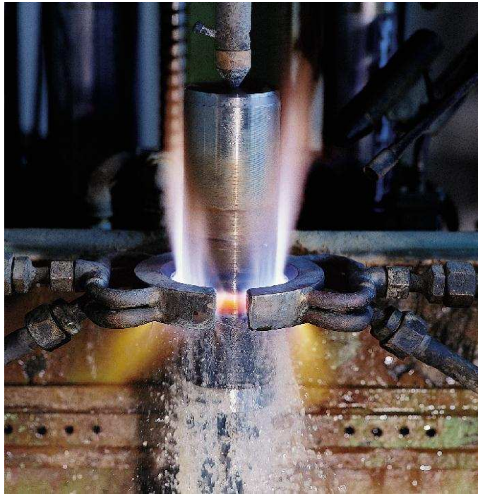
Figura 2.2- Processo de têmpera de superfície por chama. Lingehole (2009).
