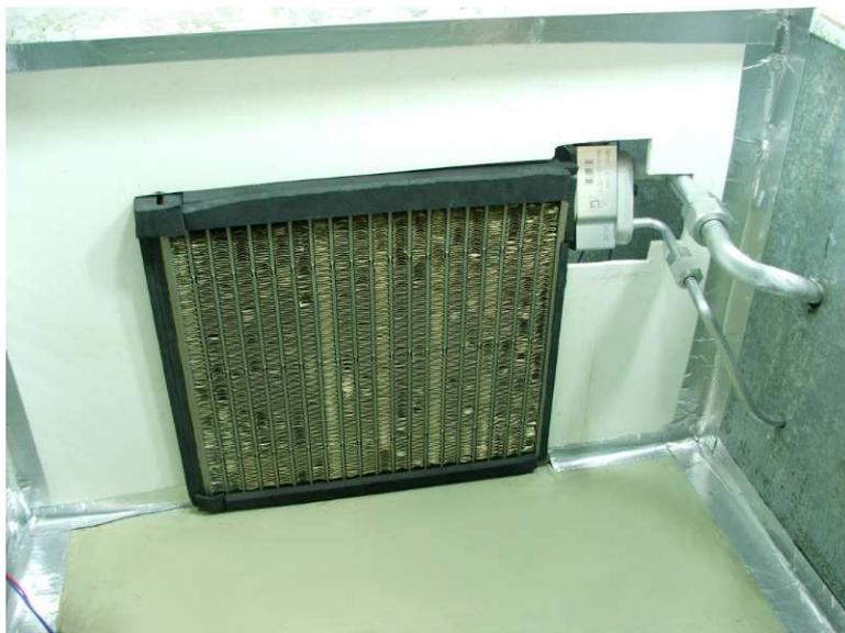
**Figura 3-15 – Fixação do evaporador com os tubos atravessando a parede do calorímetro**
