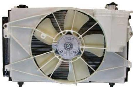
**Figura 3-2 – Foto do Condensador tipo 4 com sub-resfriamento e eletroventilador**
