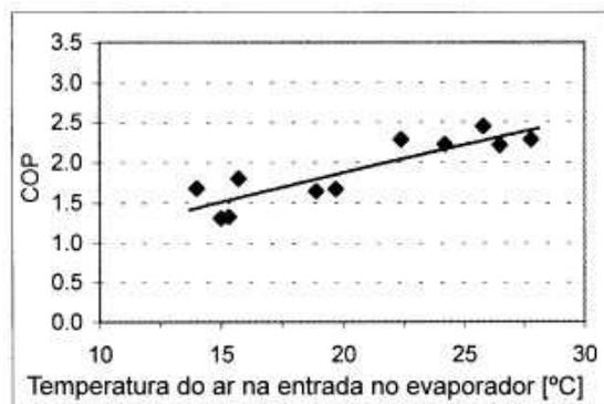
**Figura 1-12 – COP pela temperatura do ar na entrada do evaporador - Kaynakli e Horuz**
