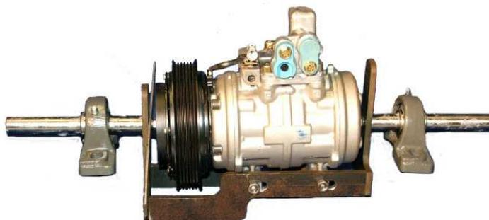
**Figura 3-29 – Foto do suporte para medição de torque com compressor**
