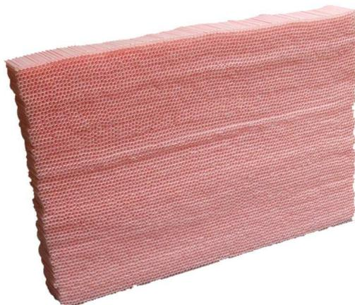
**Figura 3-13 – Tela retificadora do fluxo de ar interno do calorímetro**
