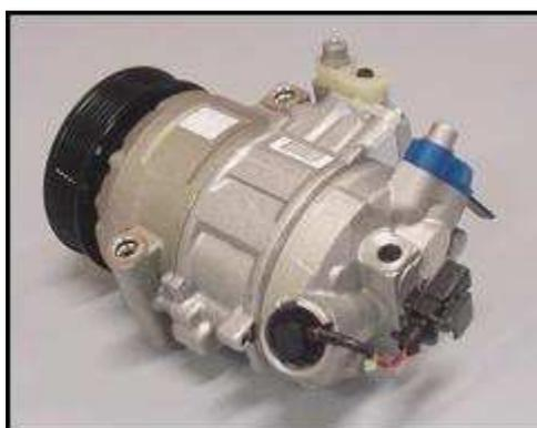
**Figura 2-6 – Compressor com capacidade variável**
