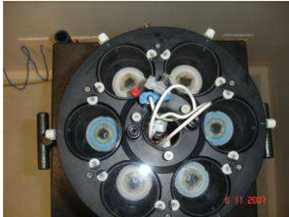
Figura 4.16 – Vista superior do simulador de fadiga mostrando as câmaras de ensaio.
