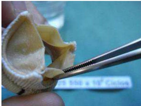
Figura 5.13 - Prótese Premium 25 mm rompida com 550 milhões de ciclos.
