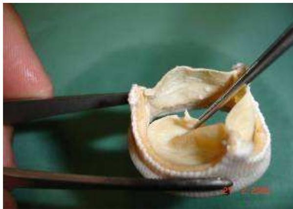
Figura 5.11 - Prótese Premium 25 mm rompida com 329 milhões de ciclos.
