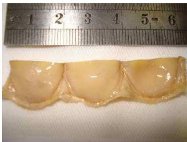
Figura 5.14 – Prótese Premium 25 mm antes do ensaio de durabilidade.
