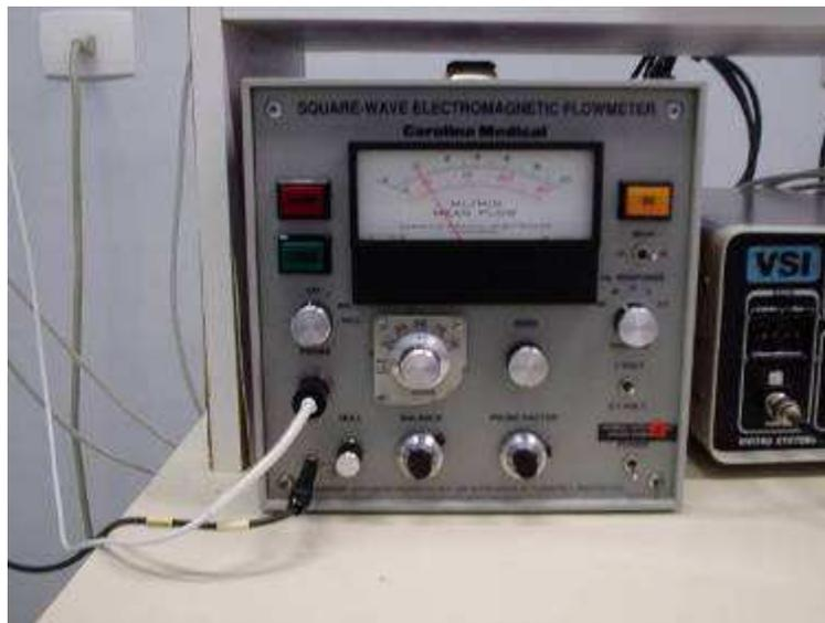
Figura 4.13 – Unidade de medição de vazão.
