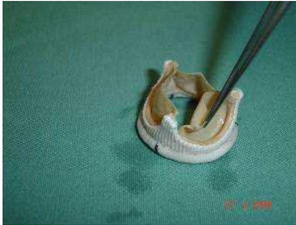
Figura 5.10 – Prótese Premium 25 mm rompida com 329 milhões de ciclos.
