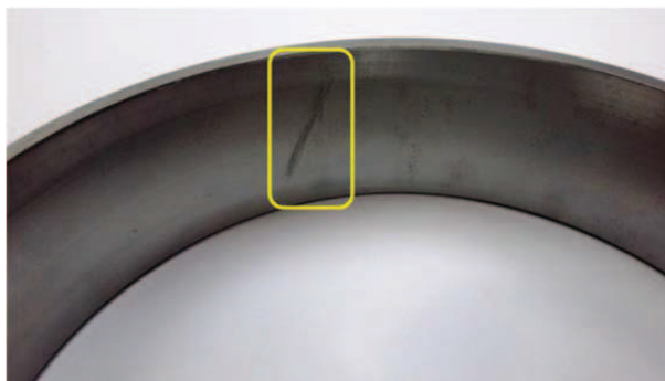
Figura 24 – Dano introduzido no câmbio D1 - risco em capa de mancal frontal inferior
