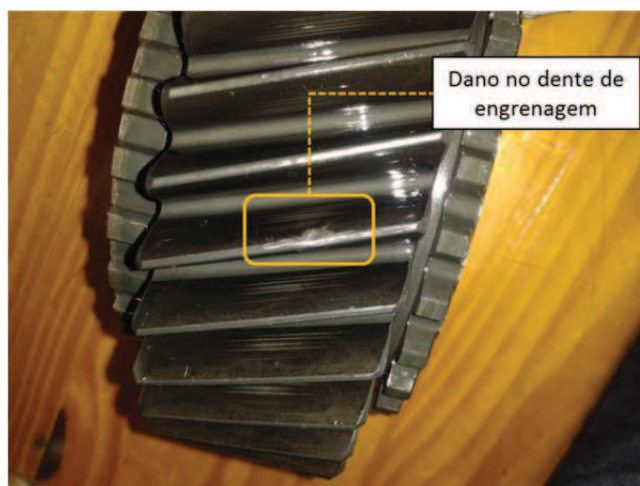
Figura 27 – Engrenagem P3 com dano localizado
