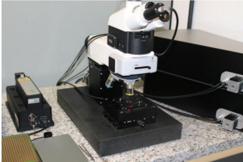
Fig A.5 - Aparelho Witec modelo Alpha 300 utilizado para espectroscopia de Raman.
