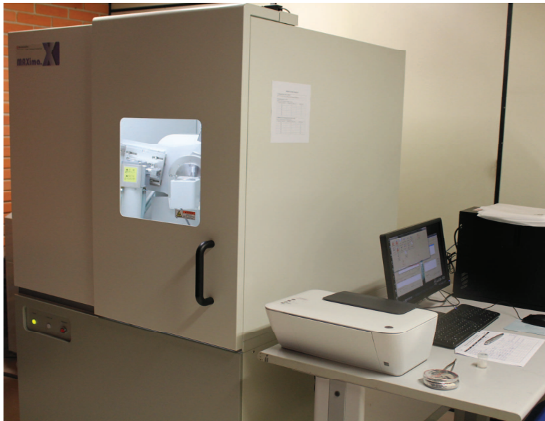
Fig A.6 -Aparelho DRX7000 Shimadzu utilizado para obtenção dos picos de hidroxiapatita.
