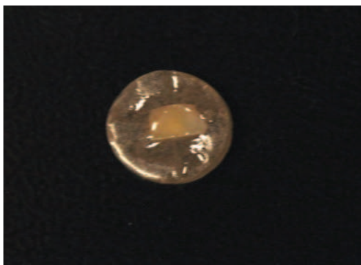
5 Fig A.2 - Espécime de esmalte 3X3mm incluídos em resina acrílica. 6 7
