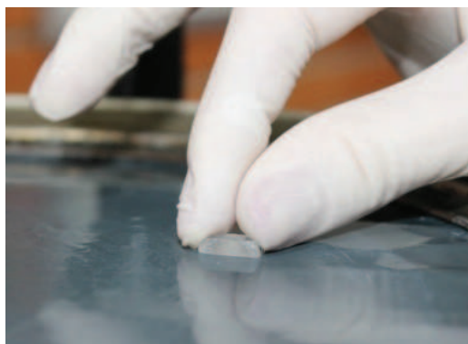
8 Fig A.3 - Padronização dos espécimes com lixa de carbeto de silício #800, 9 #1000 e #1200. 10
