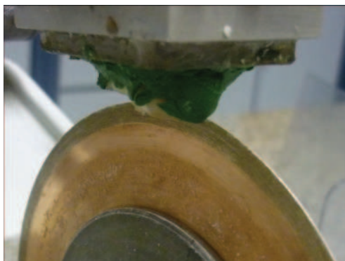
2 Fig A.1 -Corte dos dentes em cortadeira metalográfica com disco 3 diamantado. 4
