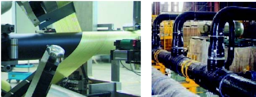
Figura 1-3 - a) risers e b) tubulações de fibra de vidro utilizadas em plataformas www.ameron.com 10/05/2005)
