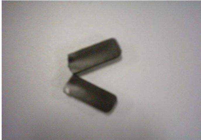
Figura 5.16 – Amostra do corpo de prova sem ruptura total no entalhe.
