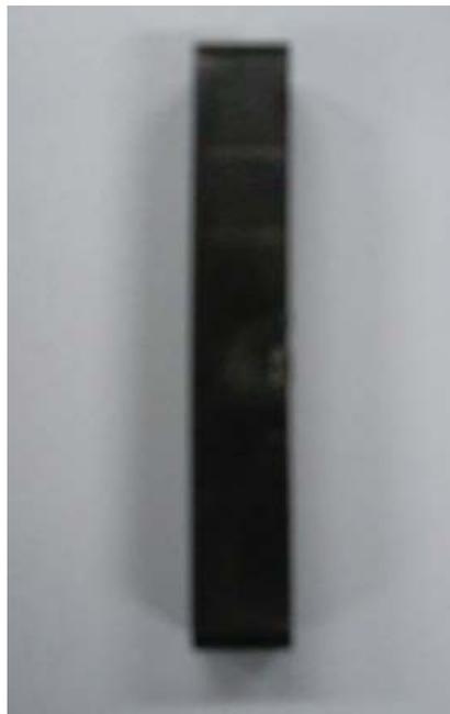
Figura 4.10 – Corpo de prova do ensaio de Charpy.
