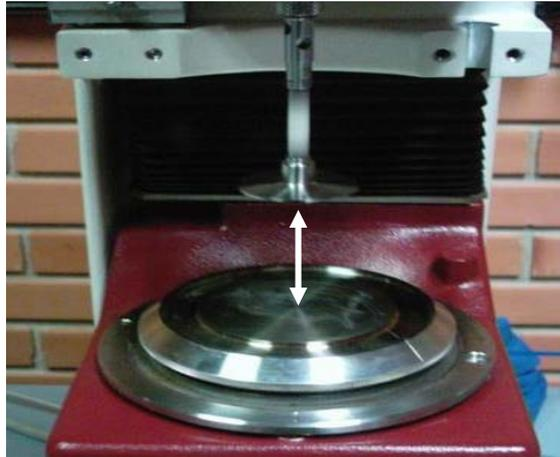
Figura 4.3 – Fotografia mostrando a distância,  $H$ , entre a placa e cone.
