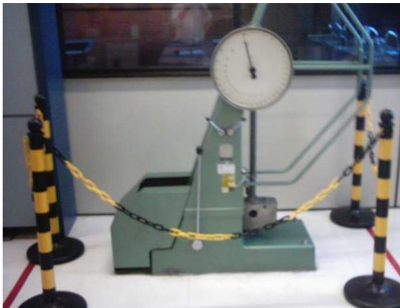
Figura 4.8 – Equipamento Pêndulo utilizado nos ensaios de impacto.
