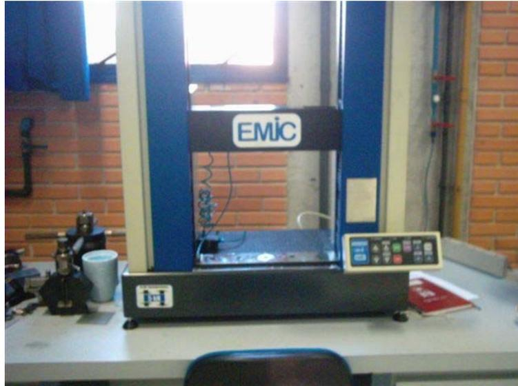
Figura 4.6 – Equipamento EMIC DL 500, para ensaio de tração.
