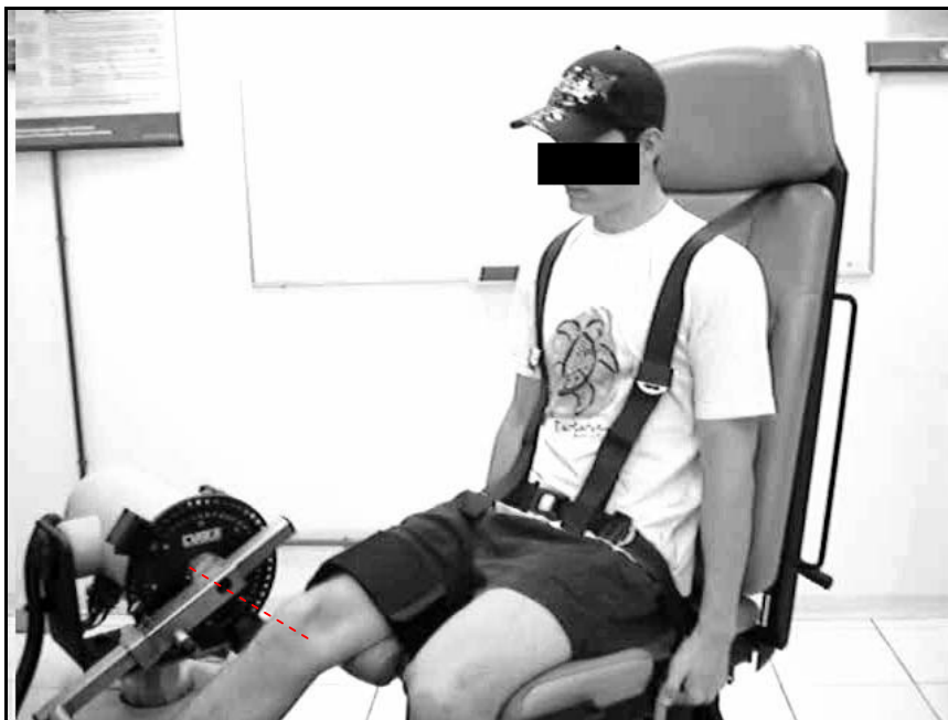
Figura 19 – Posicionamento do voluntário no dinamômetro isocinético. A linha tracejada em vermelho (-----) indica o alinhamento entre os eixos biológico e mecânico.
