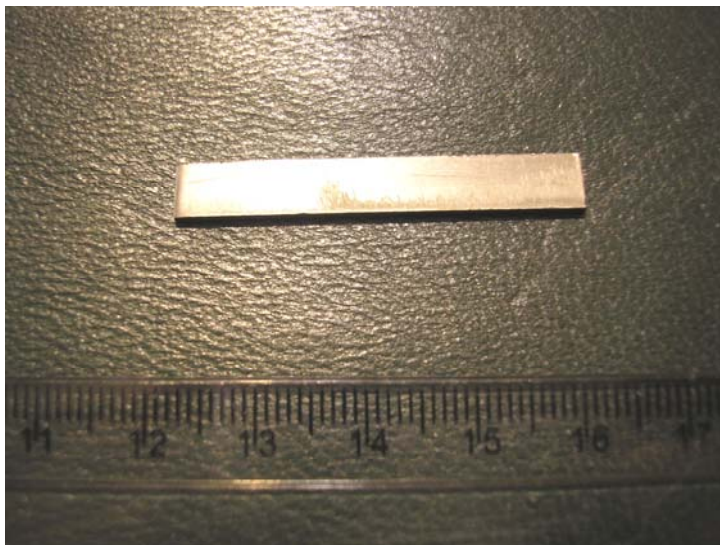
Figura 12 – Anodo de aço inox 304.
