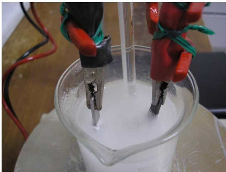
Figura 16 – Eletrodos imersos no eletrólito com o processo de deposição em curso.
