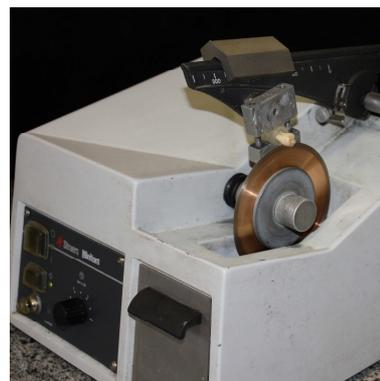
**Figura 7:** Dente fixado perpendicularmente ao disco diamantado, acoplado à máquina de corte (Struers A/S).
