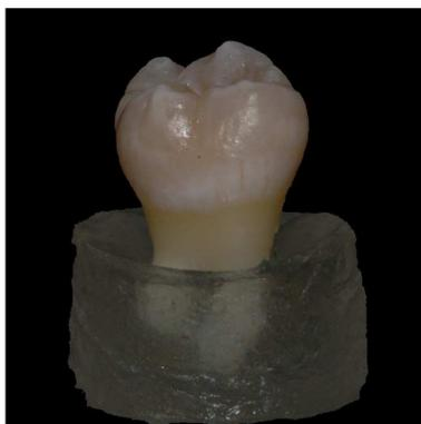
**Figura 6:** Dente embutido em resina acrílica para facilitar o corte.
