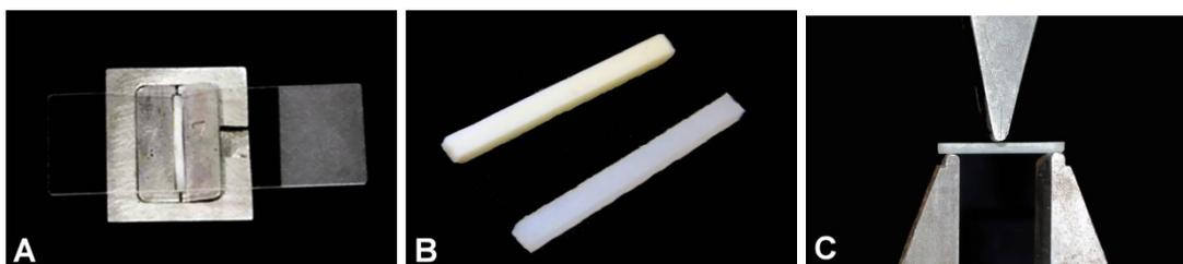
Figura 5. Confecção dos corpos de prova com matriz metálica e lâmina de microscópio (A), corpos de prova das duas resinas Transbond XT e Enlight (B) e teste de resistência à flexão na Máquina de Ensaio Mecânicos Universais EMIC (Equipamentos e Sistemas de Ensaio Ltda) (C)
