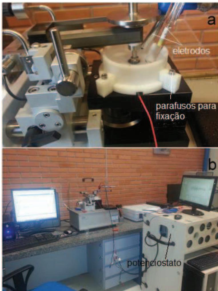
Figura 27 - Detalhe do sistema montado, com os eletrodos imersos no eletrólito (a) e imagem do tribômetro conectado ao potenciostato e aos dois computadores (b).
