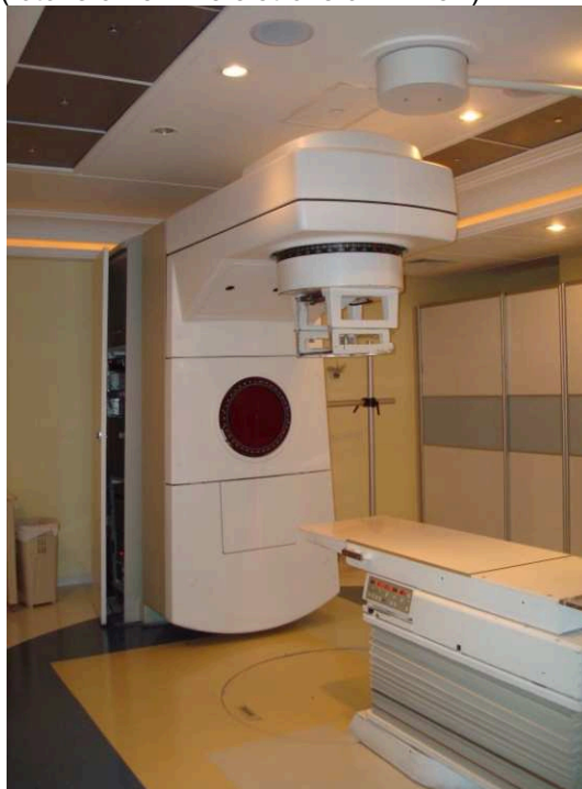
Figura 1 - Acelerador linear dual Siemens® (fótons 6-15MV e elétrons 6-14 MeV)
