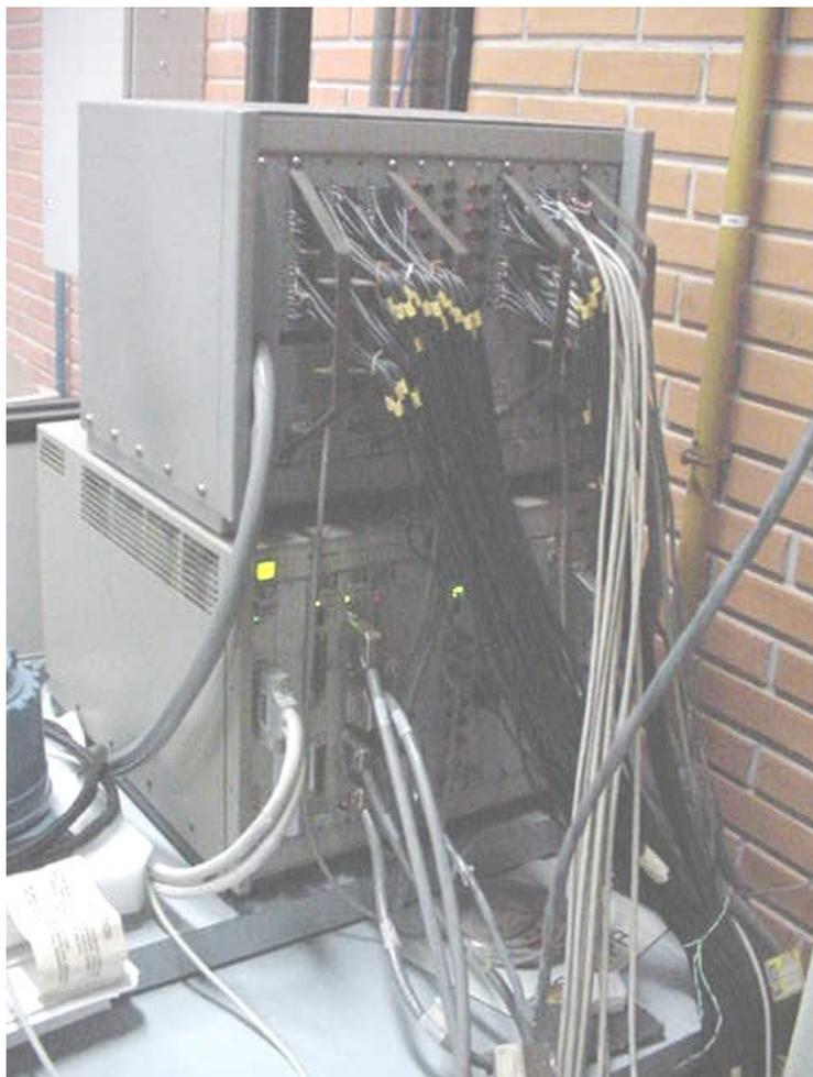
Figura 2.16. Sistema de controle e aquisição de sinais National Instruments e Tektronics com tecnologia VXI.
