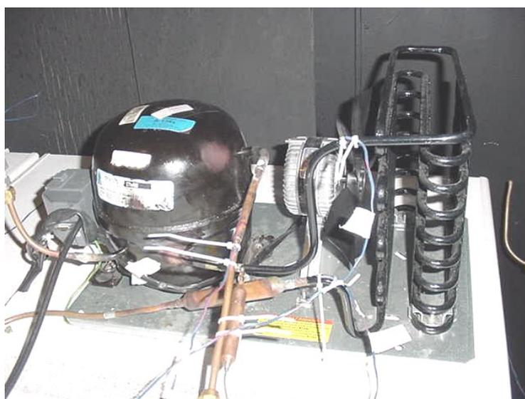
Figura 2.19. Etapa de alta pressão do sistema de refrigeração de simples compressão.
