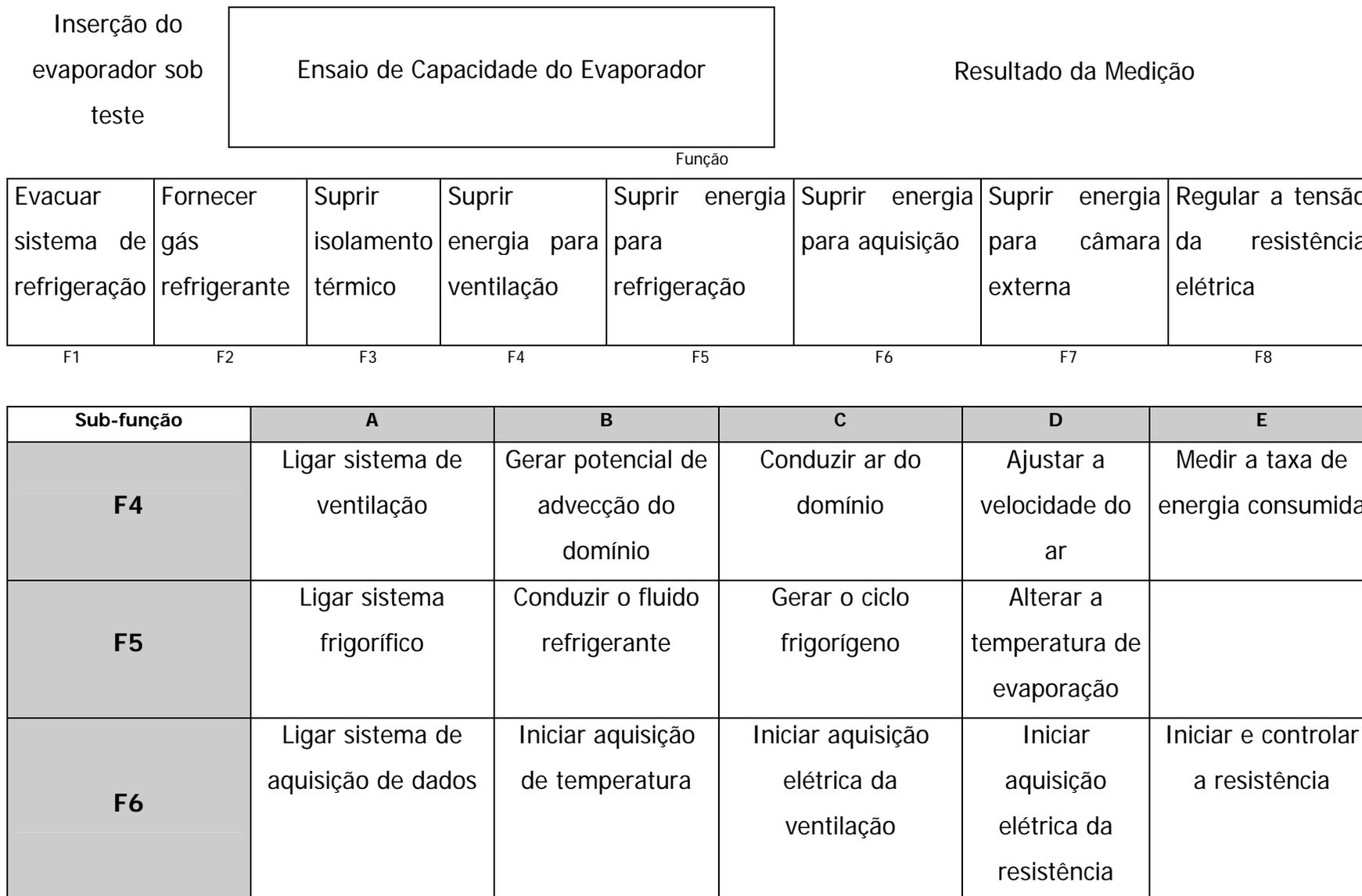
Figura A.1.1. Estrutura de funções do calorímetro.
