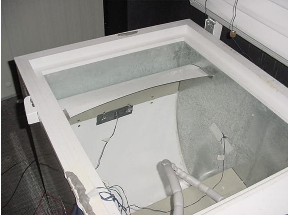
Figura 2.6. Detalhe das paredes do calorímetro, da aleta direcionadora e da partição central.
