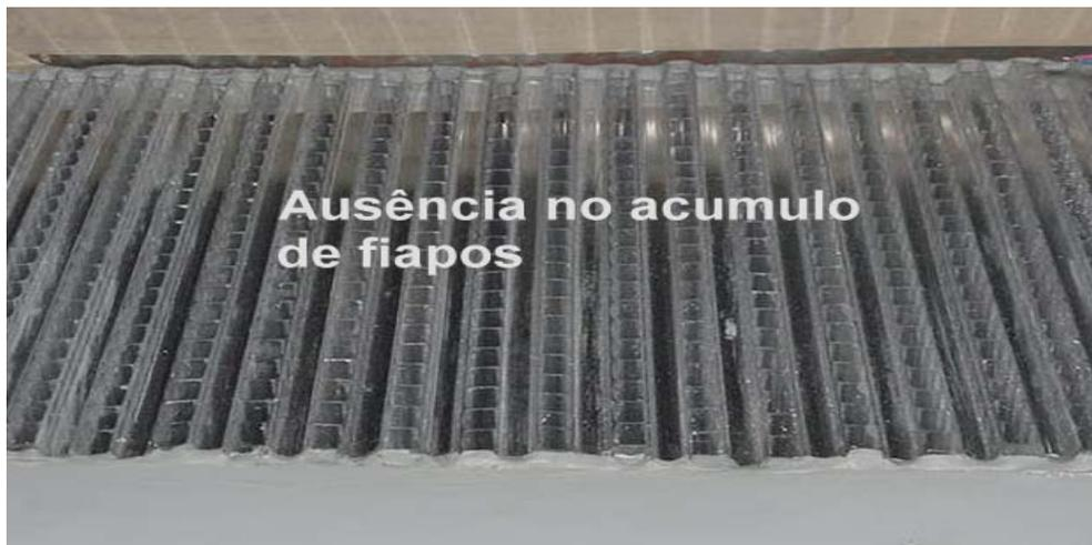
Figura 4.41 – Ausência de fiapos no lado das aletas do trocador.
