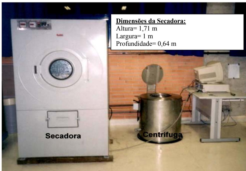
Figura 3.2 – Secadora LavexMil de 12 kg de capacidade e centrífuga.
