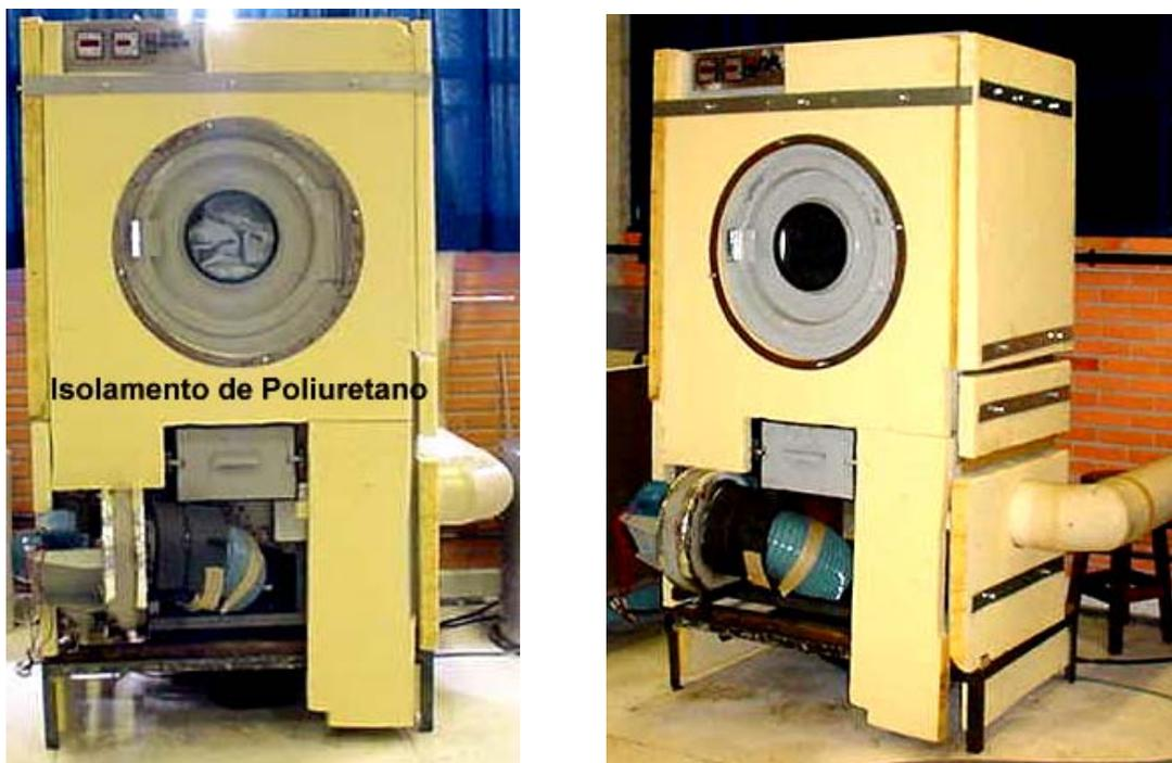
Figura 3.22 - Isolamento da secadora.
