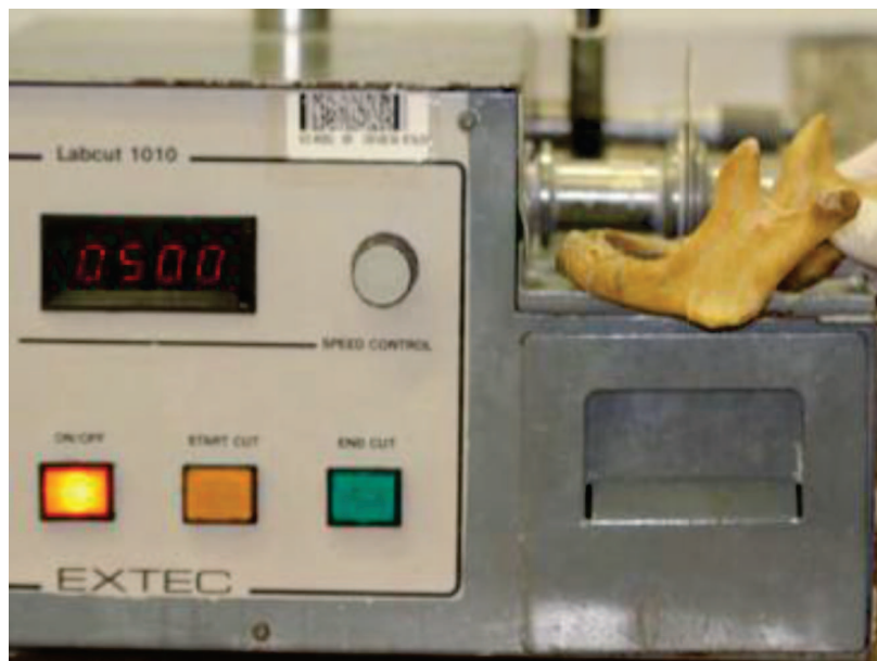
Figura 7. Mandíbula sendo cortada para obtenção dos fragmentos.
