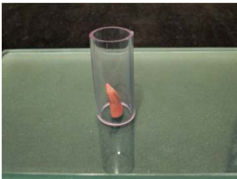
Figura 5 - Molde de PVC fixado à placa de vidro, contendo espécime para inclusão em resina de poliéster.
