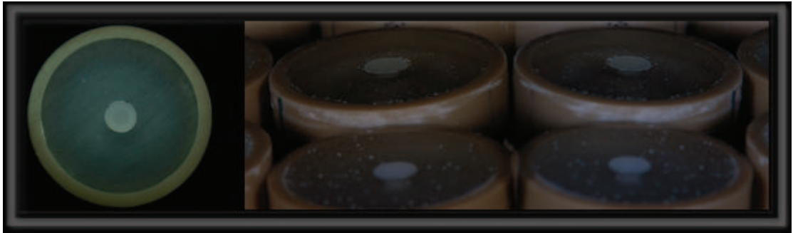
Figura 1: Cilindro de cerâmica injetada a base de Dissilicato de Lítio incluída em resina acrílica.
