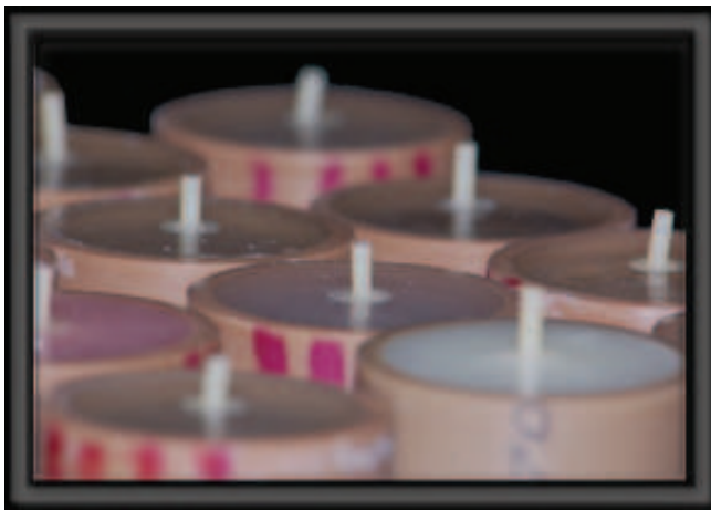
Figura 4: Cilindros de cimento resinoso confeccionados após a remoção dos tubos plásticos.
