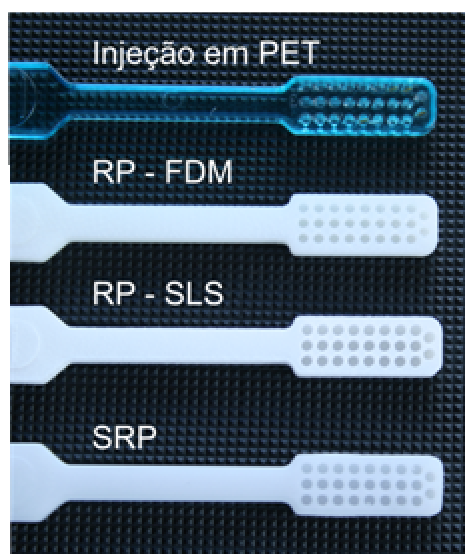
Figura 6.32. Detalhes dos furos de encerdamento.
