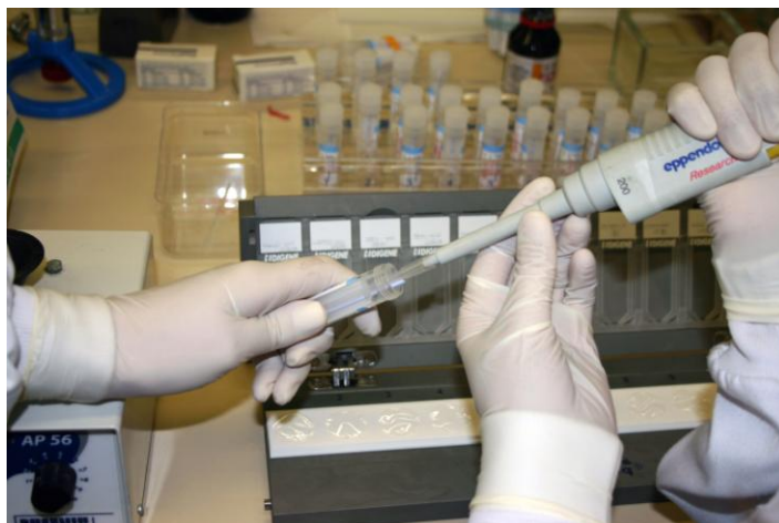
FIGURA 4 – Alíquota da amostra obtida com auxílio de pipeta monocal.
