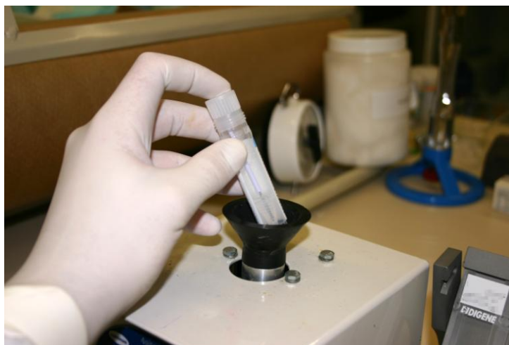
FIGURA 3 – Homogeneização das amostras no agitador de tubos do tipo vortex .
