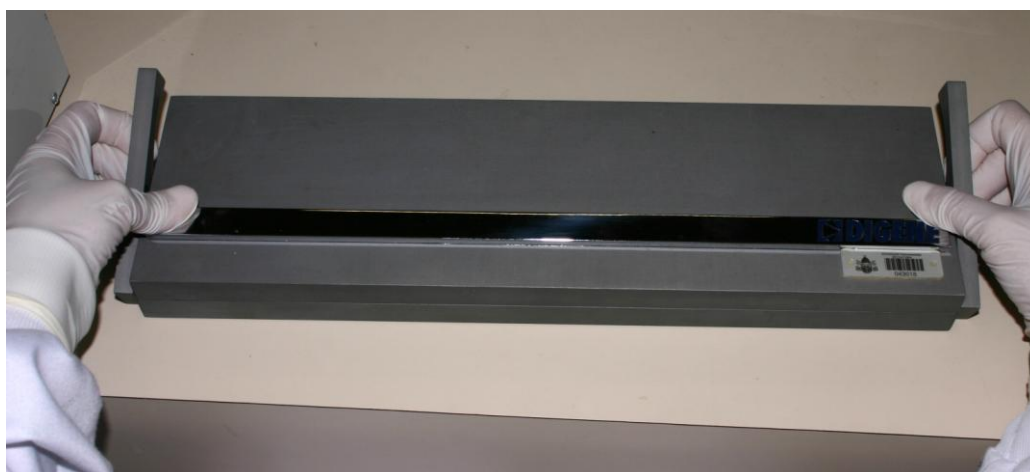
FIGURA 6 – Prensa metálica fechada para transferência celular para as lâminas de vidro.
