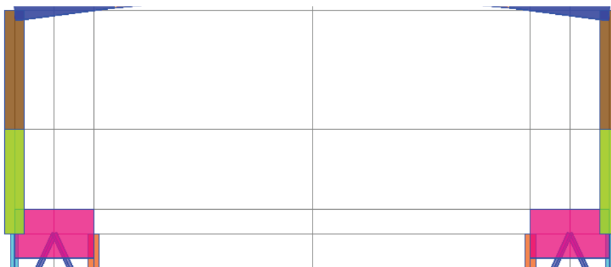
Figura 69 – Detalhe da segmentação da baioneta no modelo computacional.
