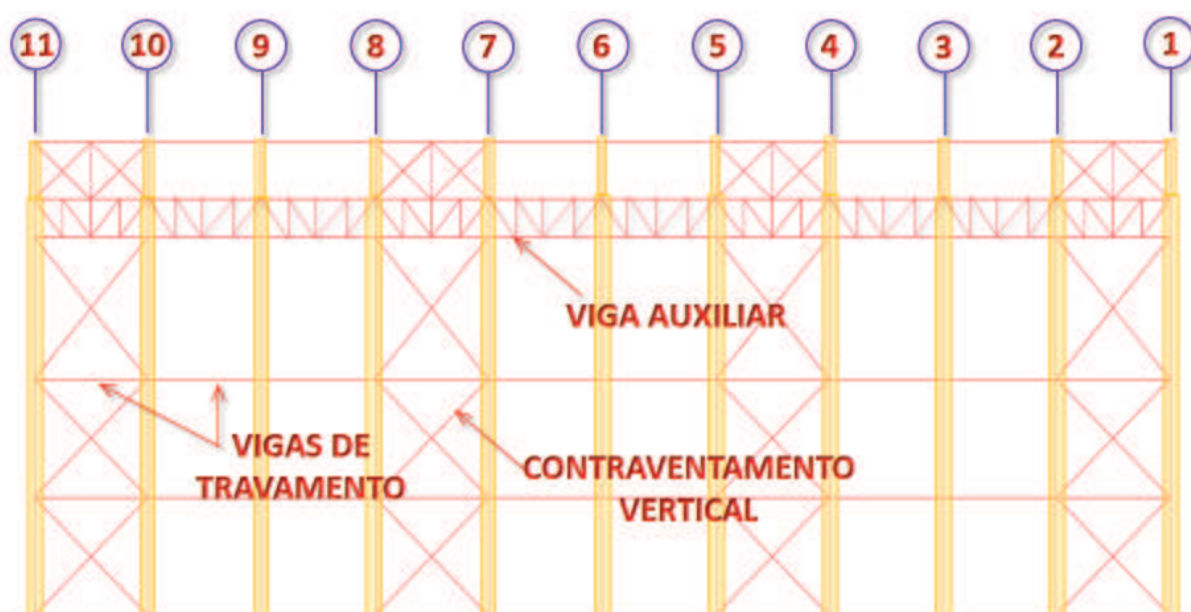
Figura 62 – Elevação lateral da Fila A.
