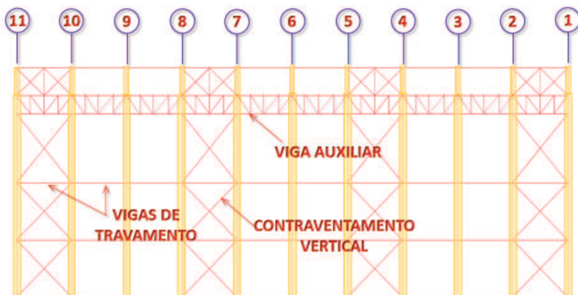
Figura 5 – Elevação lateral da Fila A.
