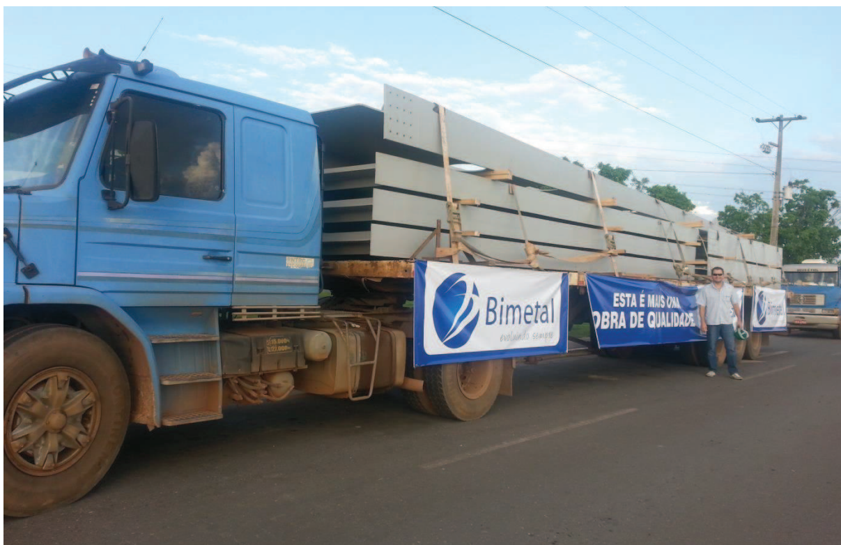
Figura 63 – Composição rodoviária carregada com estruturas metálicas.
