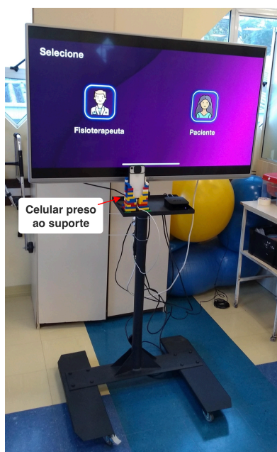
Figura 3: Instalação do sistema com espelhamento do celular na televisão.
