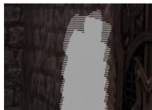
Figura 57 – Anomalia de renderização na Irrlicht causada pelo "empilhamento" de geometrias planas.
