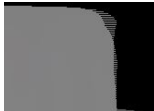
Figura 56 – Anomalia de renderização na Urho3D causada pelo "empilhamento" de geometrias planas.
