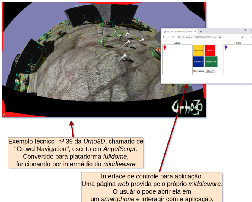
Figura 60 – Aplicação de exemplo (chamada de "Crowd Navigation") da Urho3D convertida para executar no fulldome .
