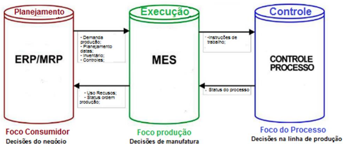
Figura 29 - MES – Sistema de Execução da Manufatura.
