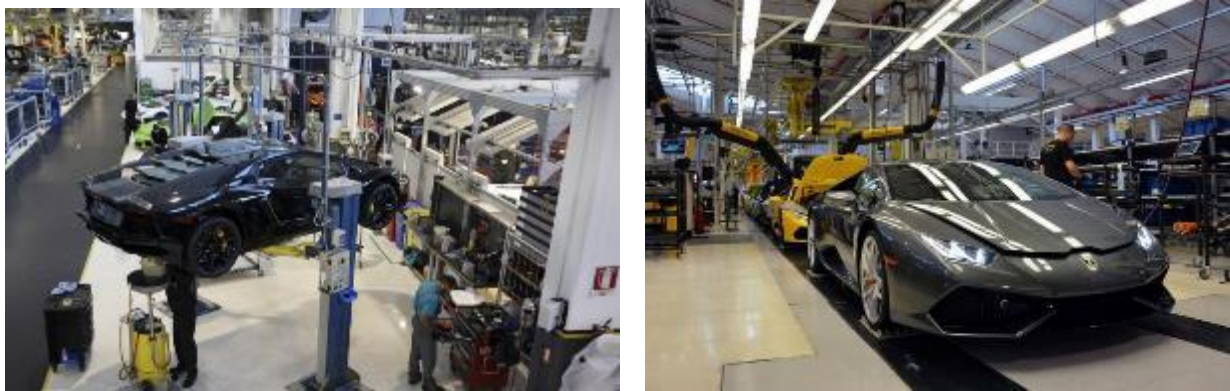
Figura 24 – Layout de Linha por Processos ou Funcional (Empresa Lamborghini ).
