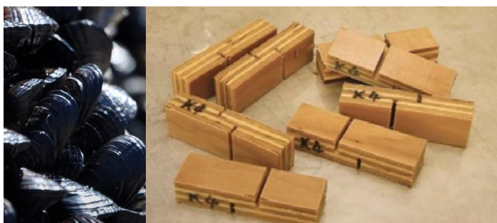
Fig. 1. (a) Mexilhões Mytilus Edulis , moluscos filtradores; (b) Purebond após ensaio de ebulição cíclico mostrando resistência superior a umidade para desempenho à prova d'água
