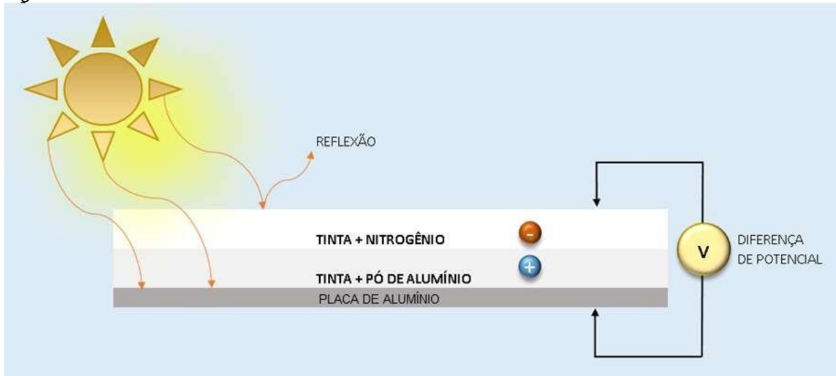
Figura 3 – Estrutura célula solar fotovoltaica a base de tinta
