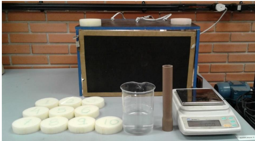
Figura 30: Medição de espuma de polímero no experimento de porosidade utilizando água.
