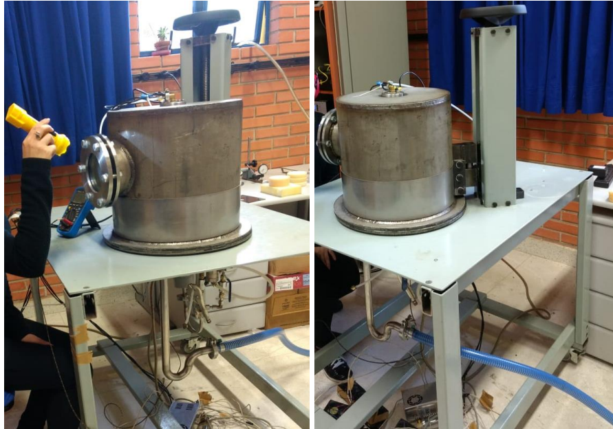
Figura 36: Medição teste na câmara de vácuo com amostra de espuma de polímero para medição de porosidade.
