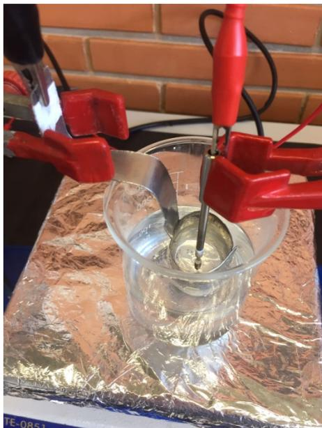
Figura 10. Célula eletroquímica utilizada na oxidação dos implantes dentários.
