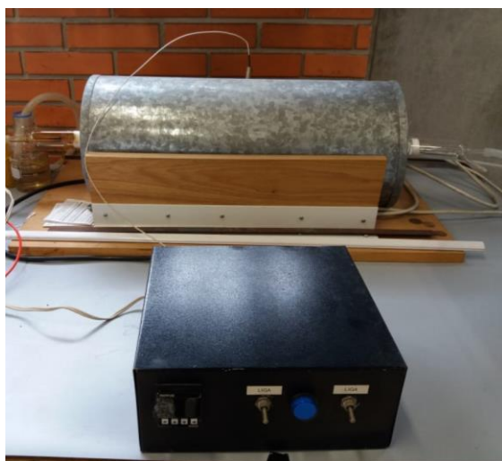
Figura 11. Forno elétrico com atmosfera controlada.
