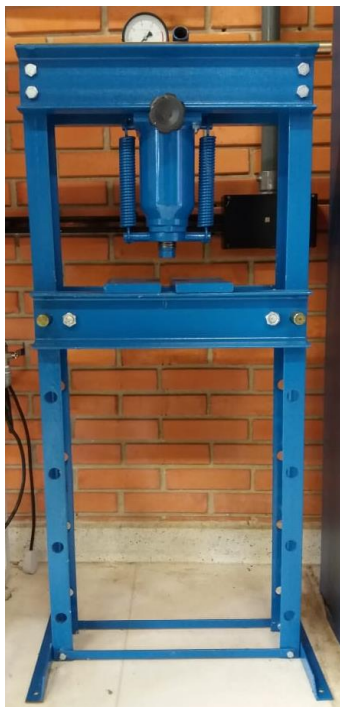
Figura 10. Prensa hidráulica manual com capacidade máxima de 15 toneladas, marca Bovenau modelo PT15500.
