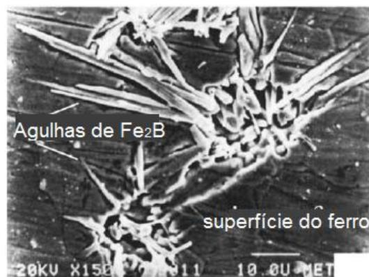
Figura 21 - Detalhes dos cristais de  $Fe_2B$
