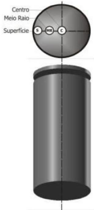
Figura 38 - Regiões da barra de ferro fundido
