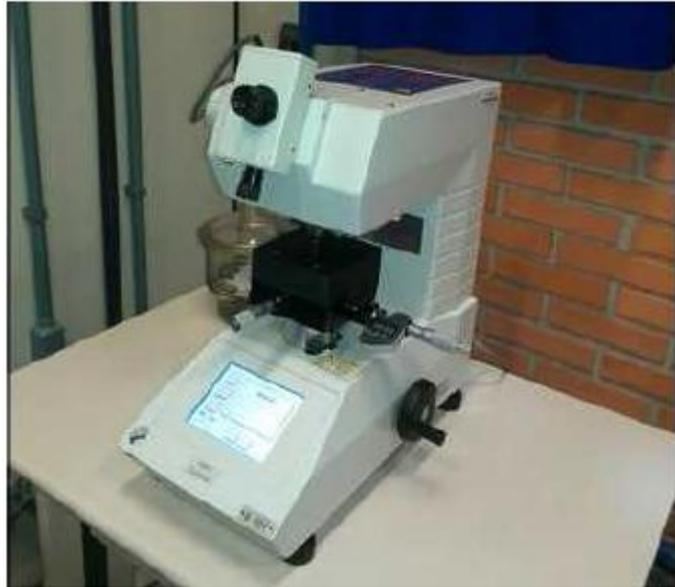
**Figura 45 - Microdurômetro Shimadzu HMV 2000**
