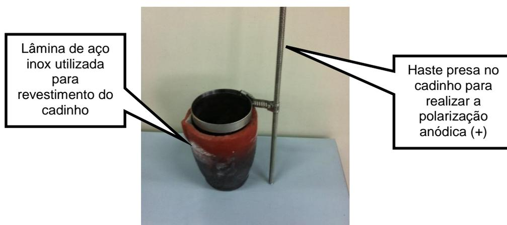
Figura 43 - Cadinho de carbeto de silício revestido com aço inox
