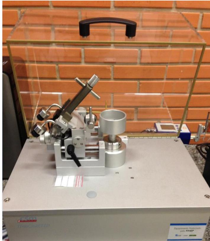
Figura 16: Equipamento tribômetro (Autor, 2020).
