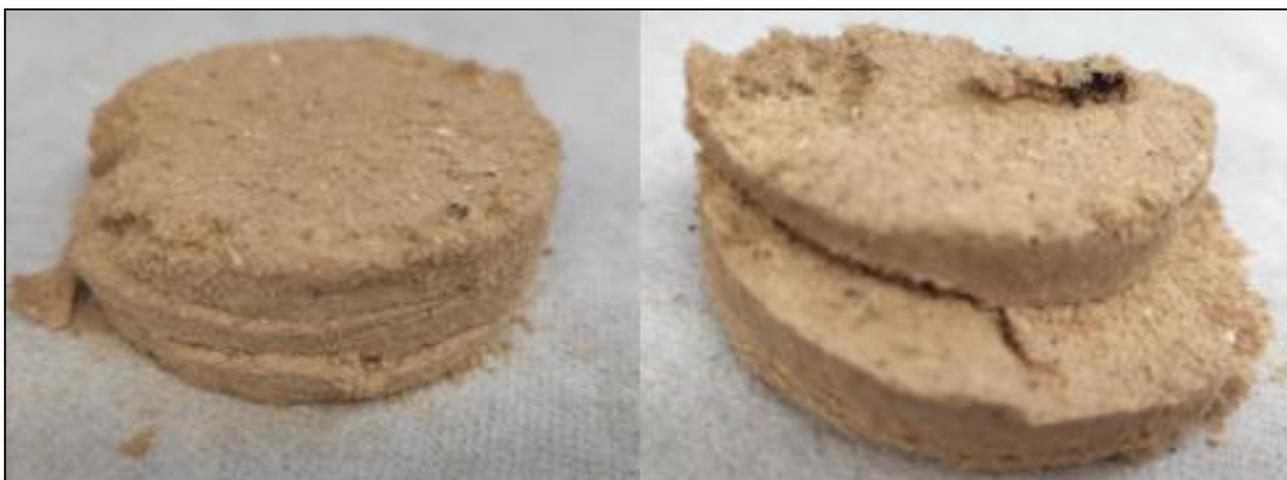
Figura 31 – Briquete de serragem de pinus após ensaio de resistência por compressão diametral.
