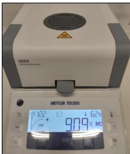
Figura 13 - Teor de umidade do pó de serra de pinus sp.
