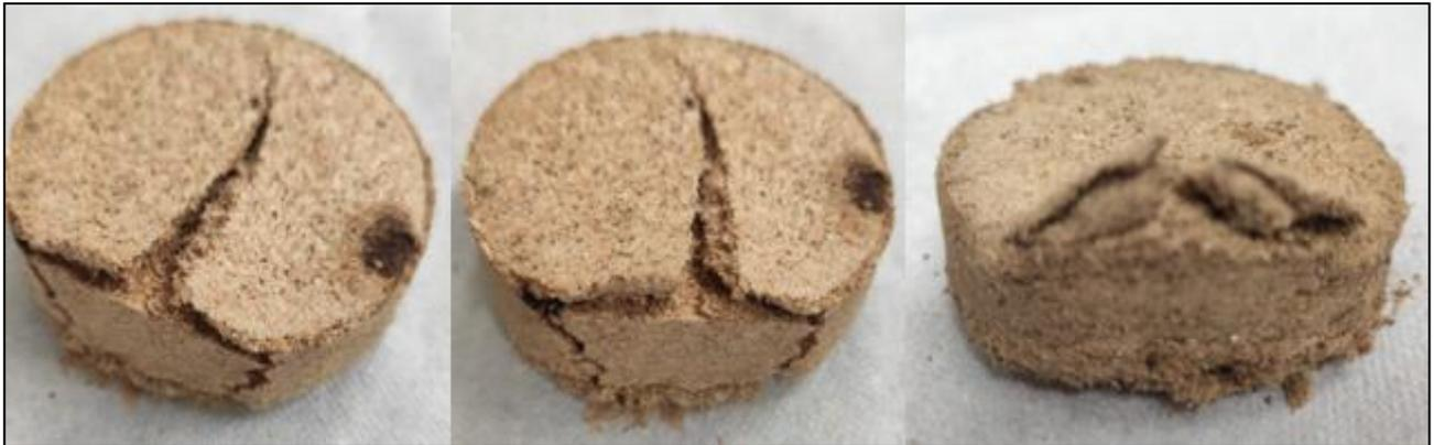
Figura 36 – Briquete de serragem de cambará com adição de borra de café após ensaio mecânico.
