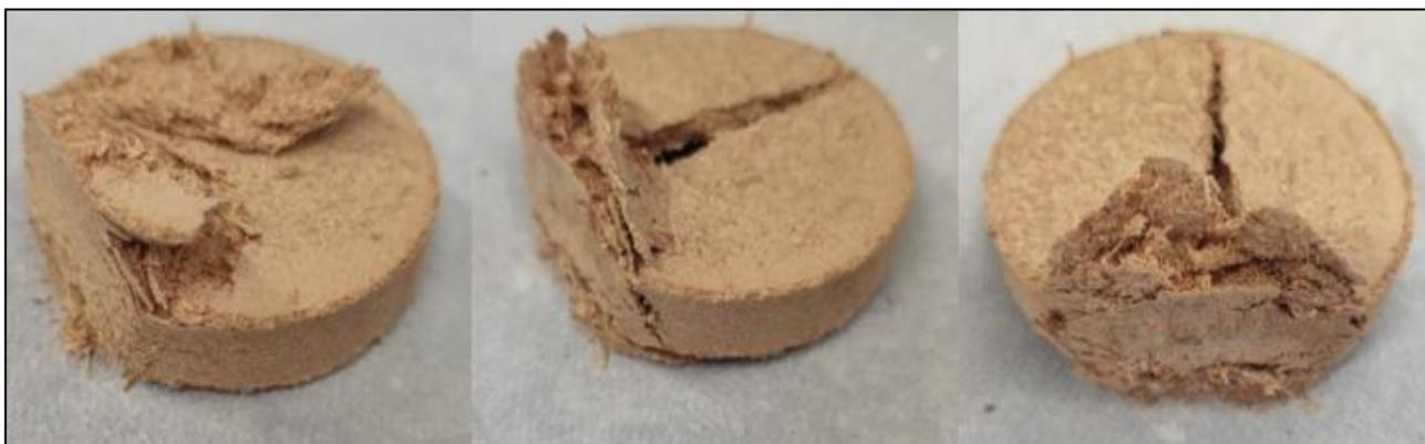
Figura 35 – Briquete de serragem de cambará após ensaio mecânico.
