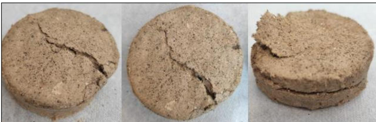
Figura 33 – Briquetes de serragem de pinus com adição de borra de café após ensaio mecânico.
