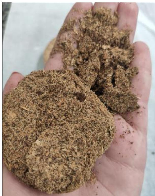
Figura 37 – Briquete C-06 após ensaio mecânico.
