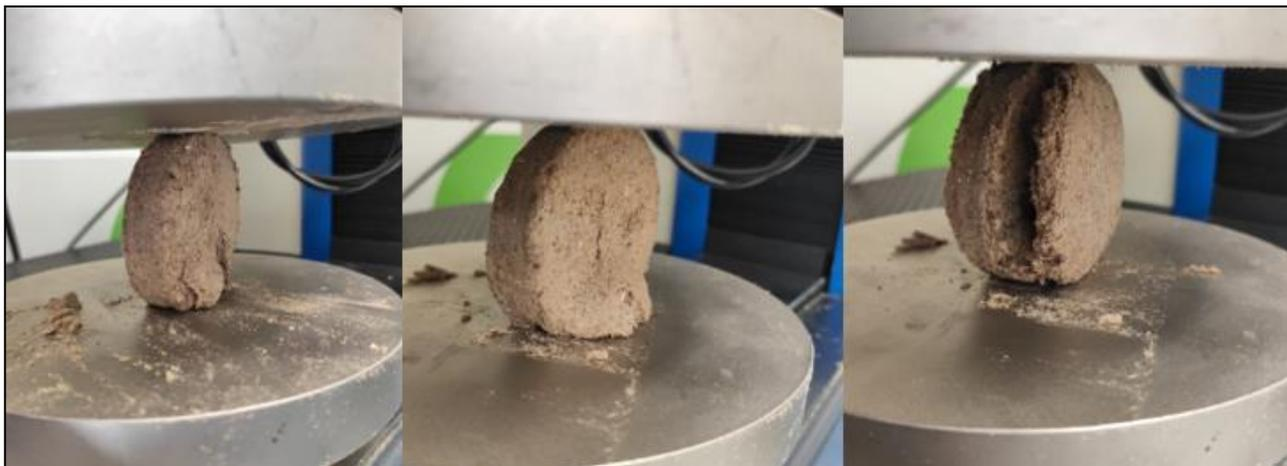
Figura 32 – Briquete de serragem de pinus com adição de borra de café no equipamento EMIC.
