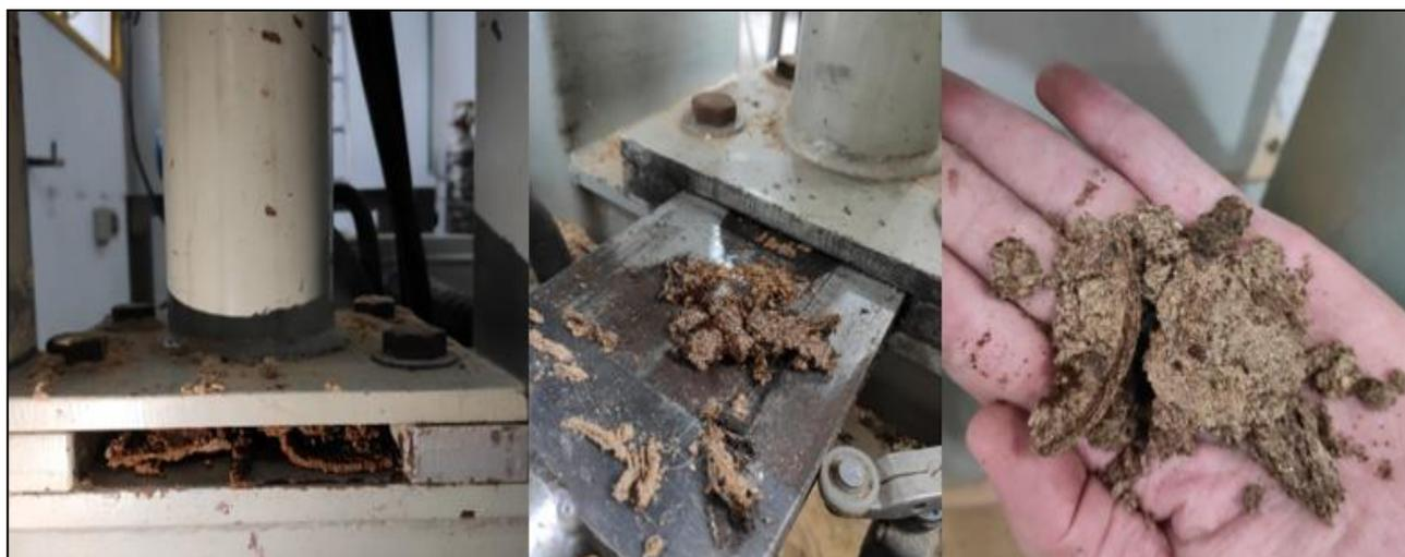
Figura 28 – Ilustração de resultados da compactação das amostras com alta adição de borra de café.
