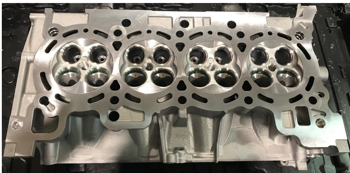
Figura 80 – Peça usinada com os novos parâmetros da fresa
