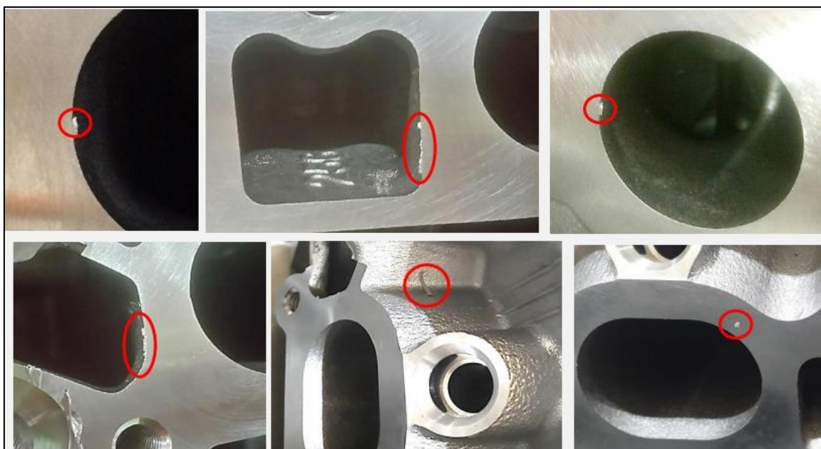
Figura 6 – Peças com acúmulo de cavacos:
