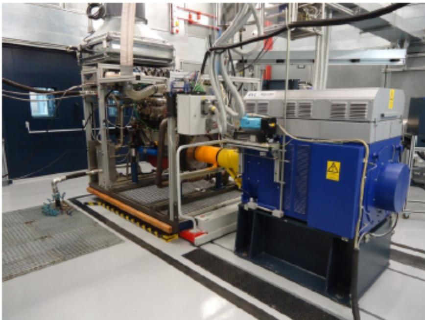
Figura 12 – Motor de ciclo Diesel e Dinamômetro
