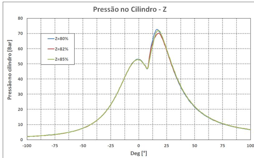
Figura 40 – Verificação da pressão medida no cilindro, variando a taxa de substituição
