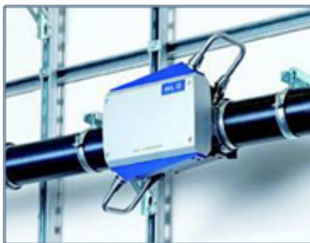
Figura 10 – Medidor do fluxo de ar de combustão AVL Flowsonix
