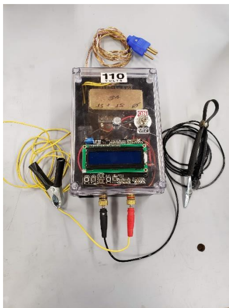
Figura 49 - Dispositivo de descarga capacitiva micro controlada Fonte: LAUS - Laboratório de Usinagem (PUCPR)
