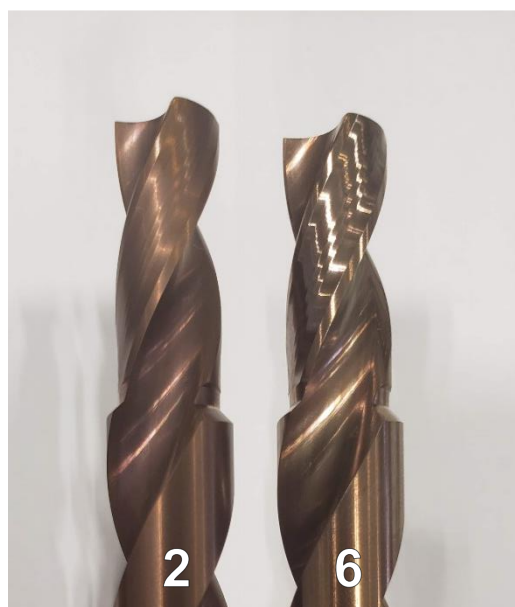
Figura 60 - Comparação visual processos de polimento – 2 (à esquerda) e 6 (à direita) Fonte: O autor (2019)
