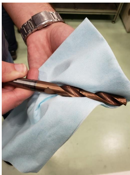
Figura 38 - Teste qualitativo para polimento em ferramentas – Restrição ao pano Fonte: O autor (2019)
