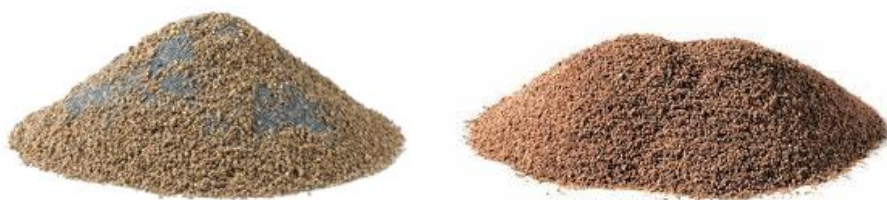
Figura 30 - Abrasivo HSC 1/300 (à esquerda) e H 4/400 (à direita) Fonte: (OTEC, 2019)
