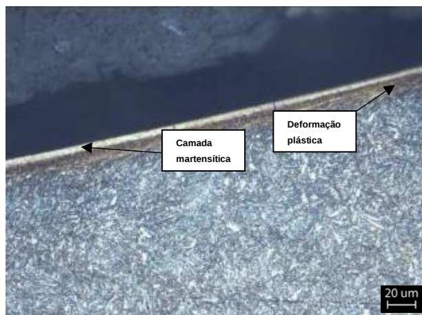
Figura 100 - Modelo de medição da camada martensítica e deformação plástica Fonte: O autor (2019)
