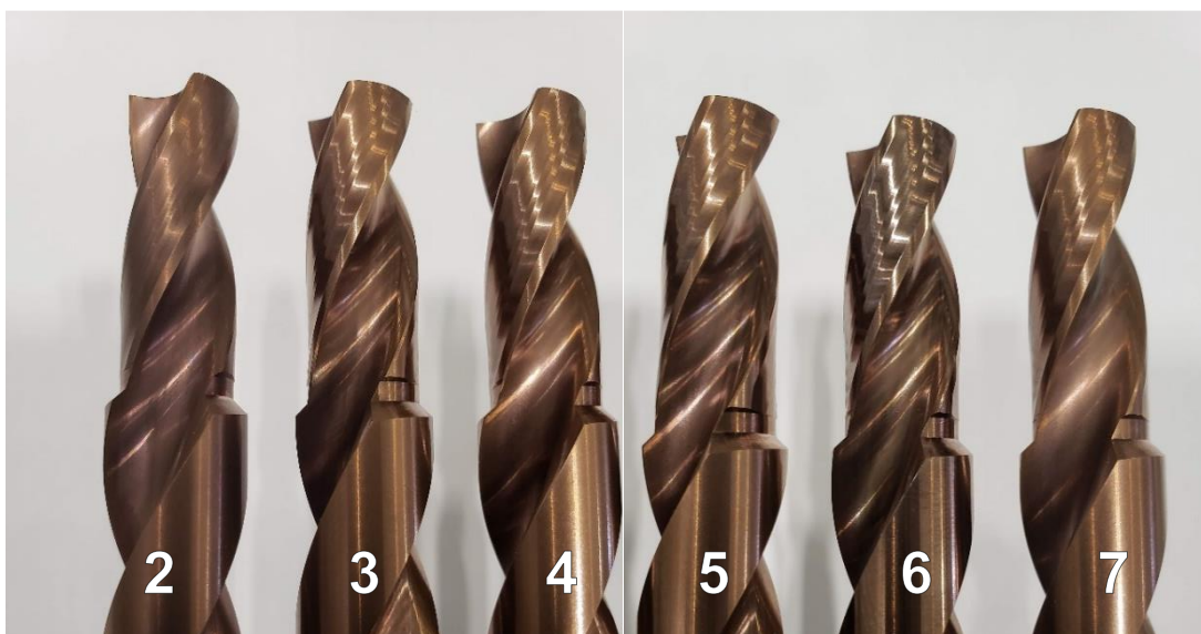
Figura 59 - Comparação visual processos de polimento Fonte: O autor (2019)
