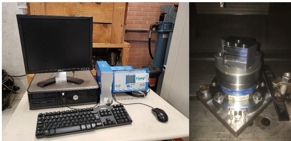
Figura 48 - Placa de aquisição de dados + amplificador e computador (à esquerda), Plataforma dinamométrica (à direita) Fonte: LAUS (PUCPR)
