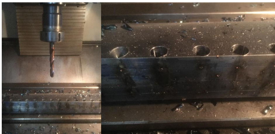
Figura 51 - Barra de aço ABNT 1020 utilizada nos ensaios de temperatura Fonte: O autor (2019)
