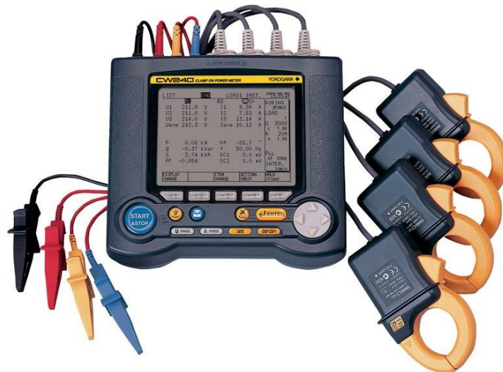
Figura 3.4 Analisador de energia portátil, modelo CW240
