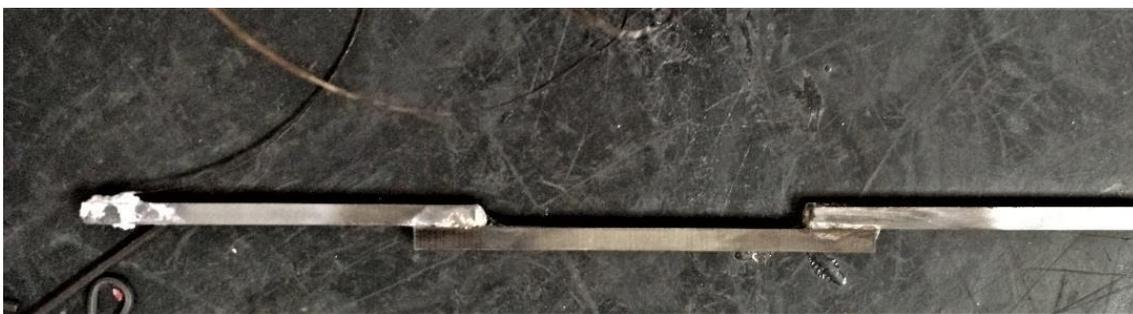
Figura 25. Termopar de aço ABNT 1020 e ferramenta de metal duro de classe P30. Fonte: O Autor (2019).
