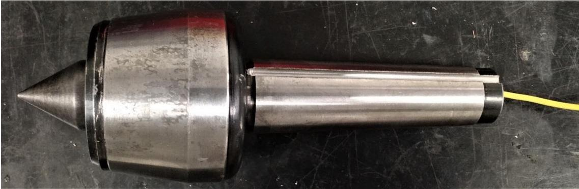
Figura 30. Contra ponta modificada, montada. Fonte: Favaretto (2017).
