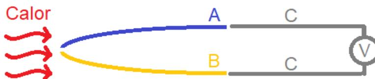
Figura 24. Esquema ilustrativo do Efeito Seebeck que rege os termopares
