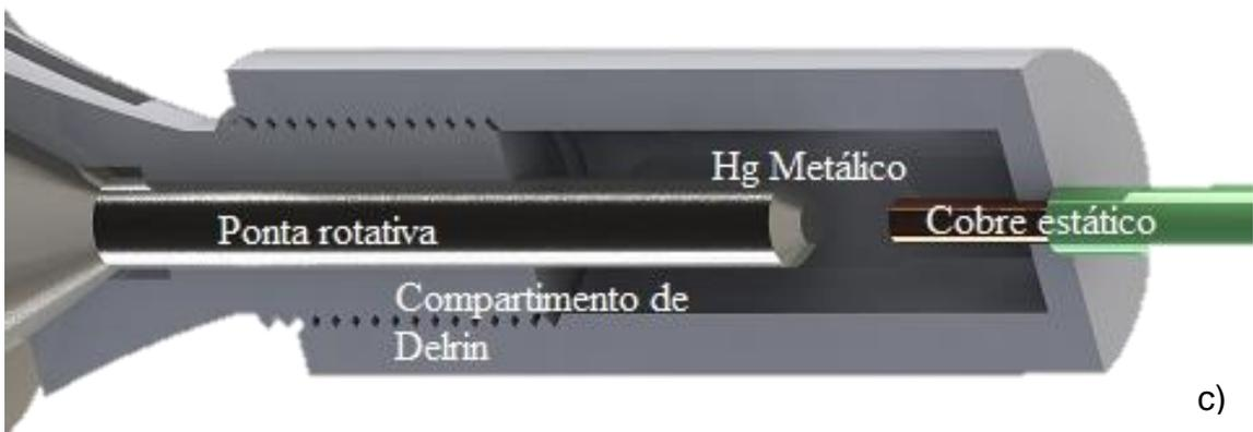
Figura 29 a) - Corte central do corpo da contra ponta; b) - Ponta rotativa isolada mostrando os elementos internos; c) - Representação do compartimento de mercúrio metálico de delrin em SolidWorks®. Fonte: Favaretto (2017, 2018).
