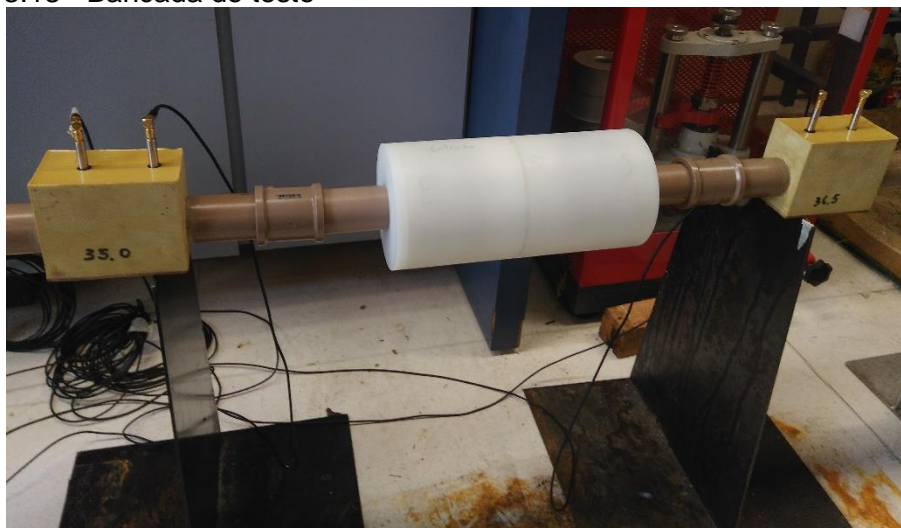
Figura 3.14 – Primeira carga do método: Terminação Anecóica
