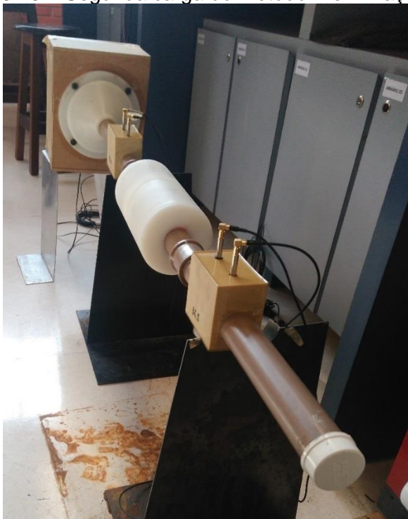
Figura 3.15 – Segunda carga do método: Terminação Rígida
