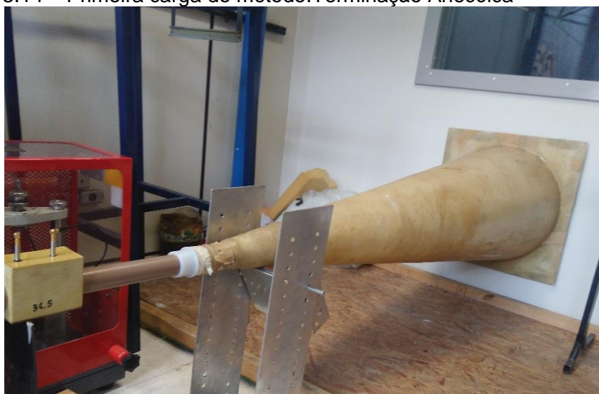
Figura 3.14 – Primeira carga do método: Terminação Anecóica
