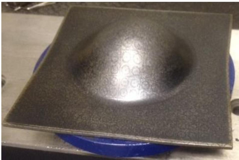
Figura 44: Corpo de prova em formato de calota esférica.
