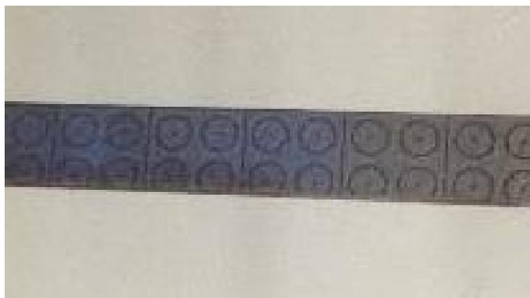
Figura 31: Malha impressa eletroquimicamente no CP.
