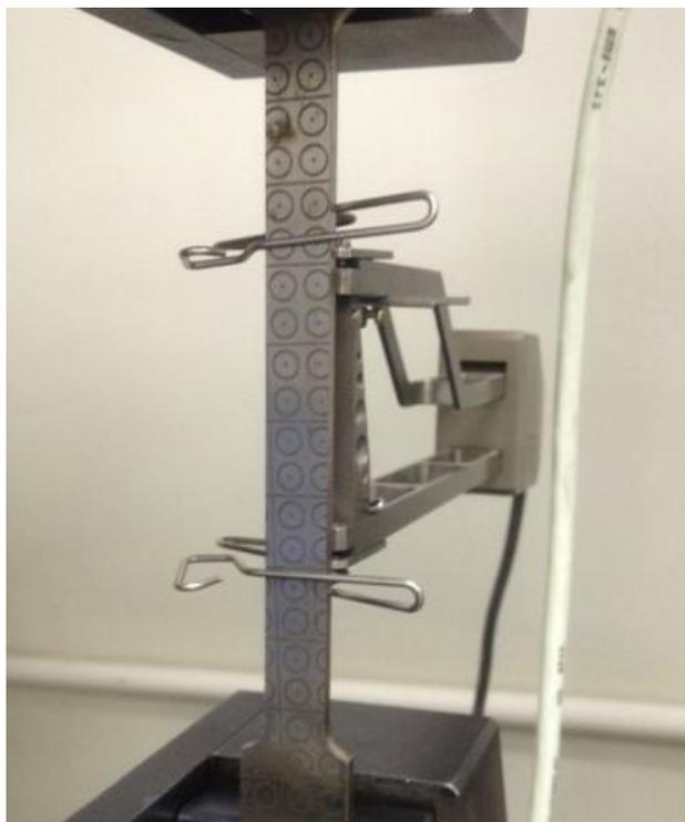
Figura 37: CP posicionado para o ensaio de tração.
