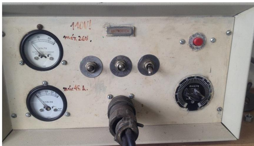
Figura 33: Fonte elétrica AC/DC do laboratório de conformação da UFPR.
