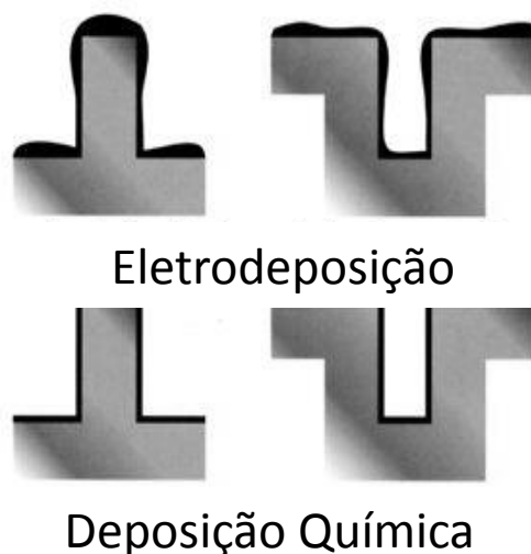
Figura 2.1.1 – Esquema mostrando a vantagem em se utilizar o processo níquel químico à eletrodeposição.
