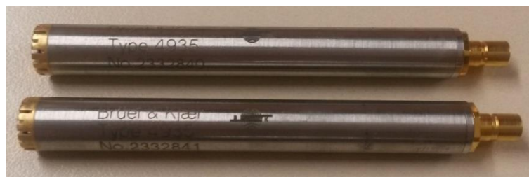
Figura 5.7 – Microfones Brüel & Kjaer Type 4935 de ¼” pré-polarizados.
