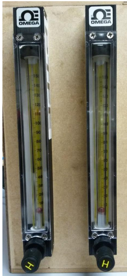
Figura 5.14 – Rotâmetro para controle de vazão.
