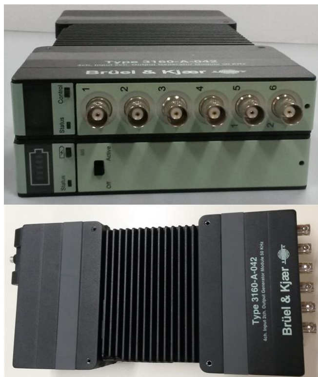
Figura 5.6 – Analisador e gerador de sinal Brüel & Kjær Type 3106-A-04.
