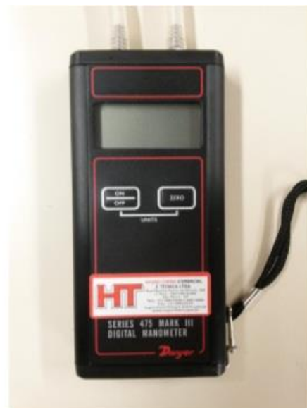
Figura 5.15 – Transdutor indicador de pressão diferencial: (a) 616WL-22 e (b) 475-000-FM.
