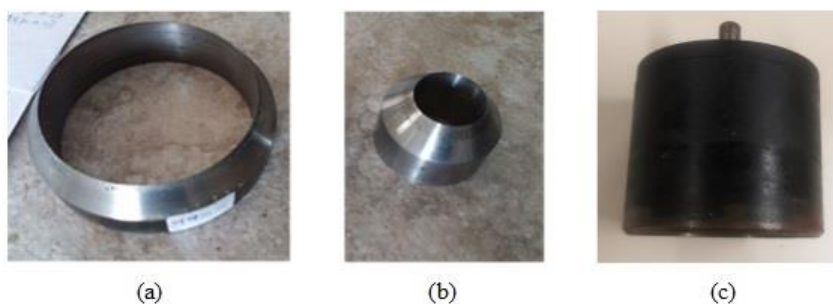
Figura 5.4 – Ferramentas para corte das amostras: (a) Ø 100 mm, (b) Ø 28 mm e (c) Ø 80 mm.
