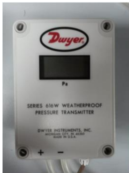
Figura 5.15 – Transdutor indicador de pressão diferencial: (a) 616WL-22 e (b) 475-000-FM.
