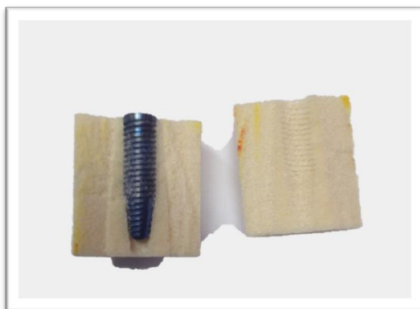
Figura 13. Poliuretano Sawbones cortado com implante após inserção.
