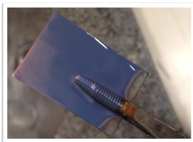
Figura 5. Placa e Implante em titânio, após anodização 60V – 6h.
