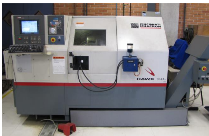
Figura 29 – Torno CNC CINCINNATI MILACRON com o aplicador de MQL instalado. Fonte própria.
