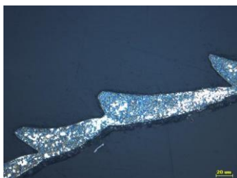
Martensita + Ferrita e Perlita
