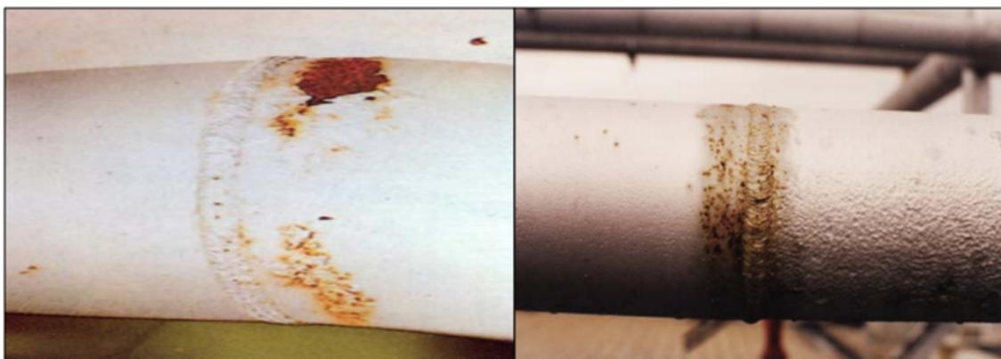
Figura 6. Corrosão em tubulação em região próxima à solda.
