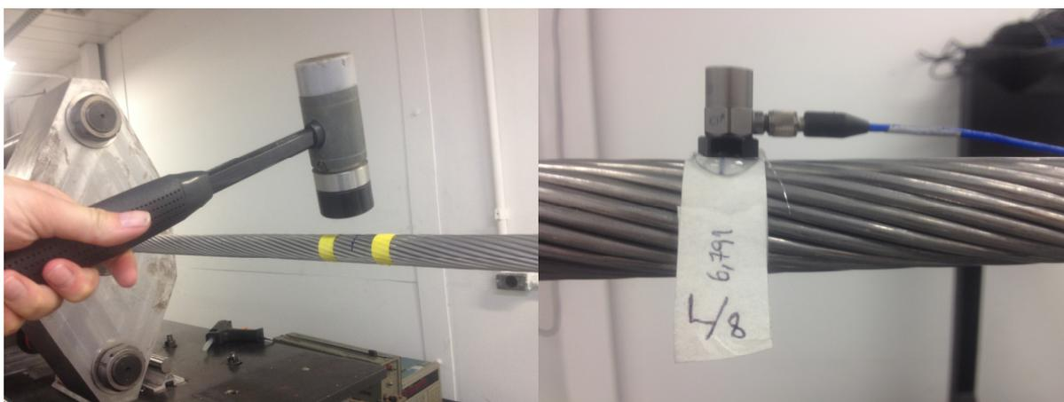
Figura 5.3: Excitação com martelo de impacto e posicionamento acelerômetro.
