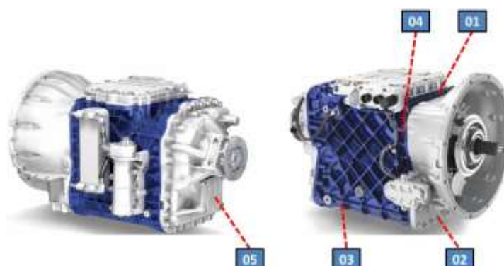
Figura 13 – Posicionamento dos Acelerômetros no corpo de prova
