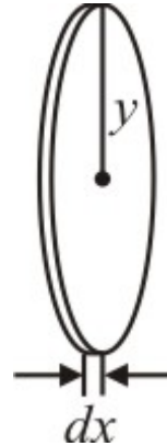
Figura B – Plana de desgaste definido na extremidade da esfera representado por um cilindro
