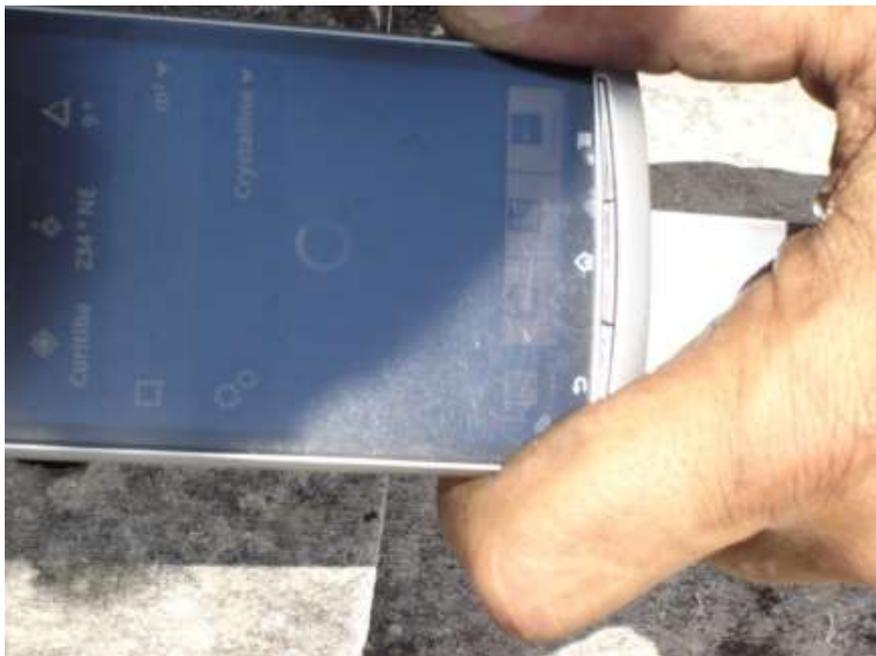
Figura 37 Verificação do ângulo de instalação.
