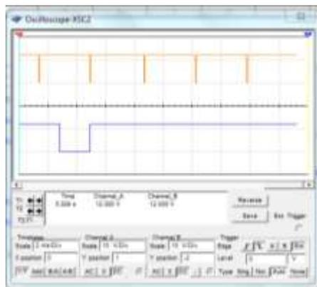
Figura 60 Resultado da simulação com os sinais nos pinos 5 e 9, com R3 a 75%.
