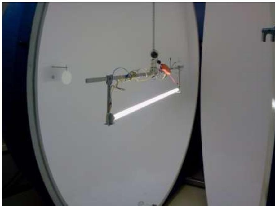
Figura 33 Ensaio na esfera com fluorescente.
