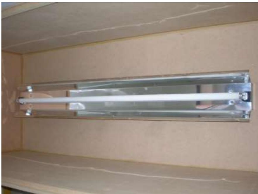
Figura 25 Caixa com lâmpada fluorescente (32W, 2700lm)
