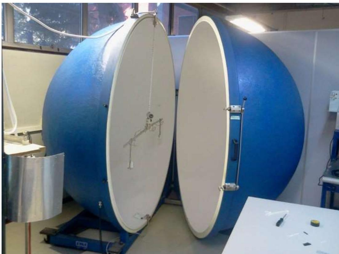
Figura 32 Esfera de ensaio luminotécnico.
